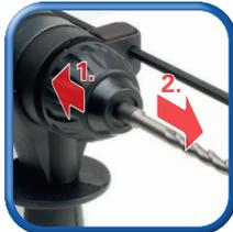
Schnellspannfutter zurückziehen, Bohrer entfernen
